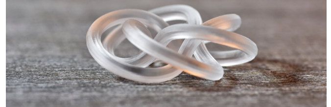
Mittels SLE hergestellte Knotenstruktur | © Lightfab GmbH
