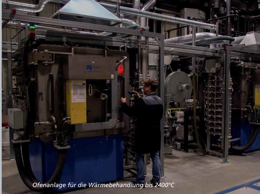
Ofenanlage für die Wärmebehandlung bis 2400°C
