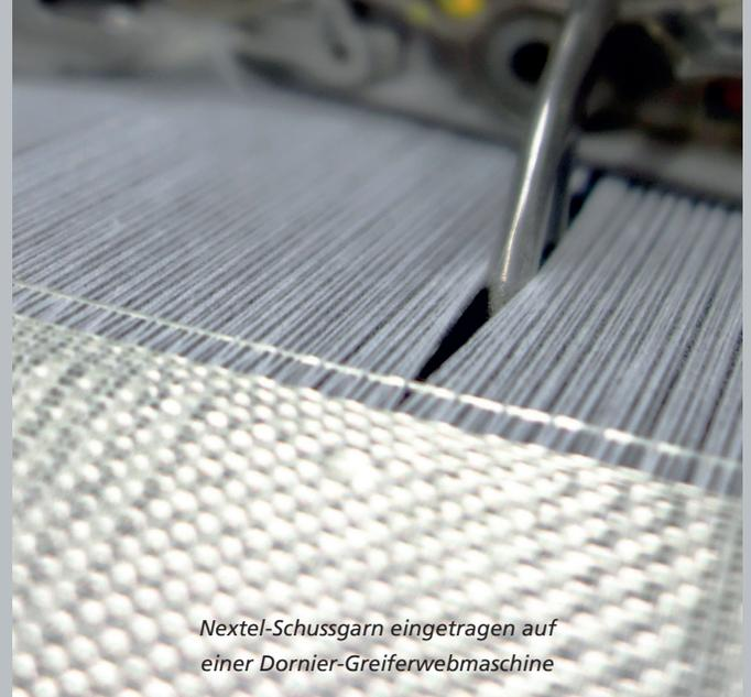
Nextel-Schussgarn eingetragen auf einer Dornier-Greiferwebmaschine
