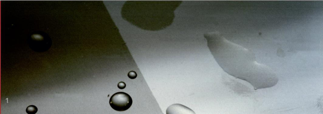
1 Links ist die Edelstahloberfläche mit dem Hybridpolymer ORMOCER® beschichtet: Wassertropfen perlen ab und Fingerabdrücke sind hier kaum zu erkennen, ganz im Gegensatz zur unbeschichteten rechten Hälfte.
