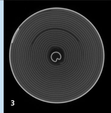
**1-3** Öffnung unter Schutzgasatmosphäre und CT-Aufnahme einer Standard Lithium-Ionen-Batterie
